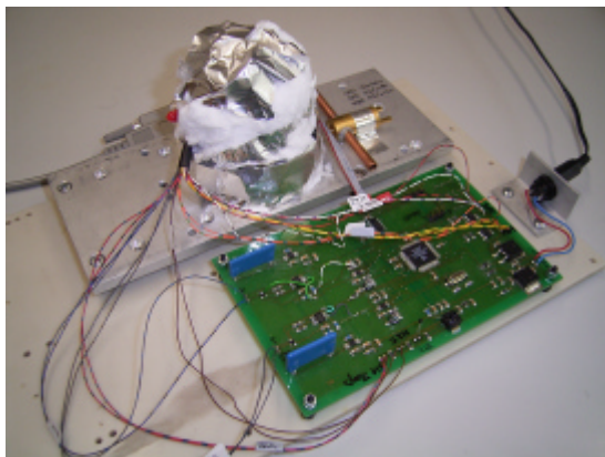
Abb. 4: erste Aufbaustufe des Zweikomponenten-WLD (isoliert) mit Ansteuerelektronik
